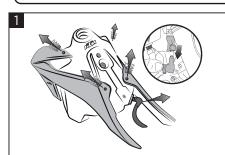
Remove the radiator scoops. Disconnect the fuel pump cover cable and the fuel connector as indicated in the diagram. Togliere i fianchetti. Sconnettere il cavo di alimentazione della pompa. Scollegare connettore benzina
